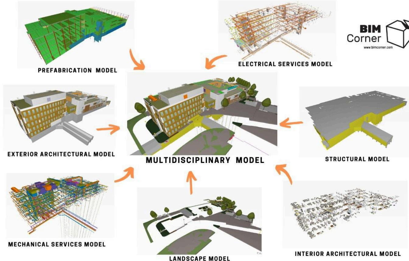
BIM usklajeni 3D model omogoča kombiniranje modelov iz različnih strok (arhitektura, konstrukcija, elektrika, ogrevanje, prezračevanje itd.)
